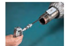
付属のノズルアダプターでベアリングを取り外さずに簡単注入
