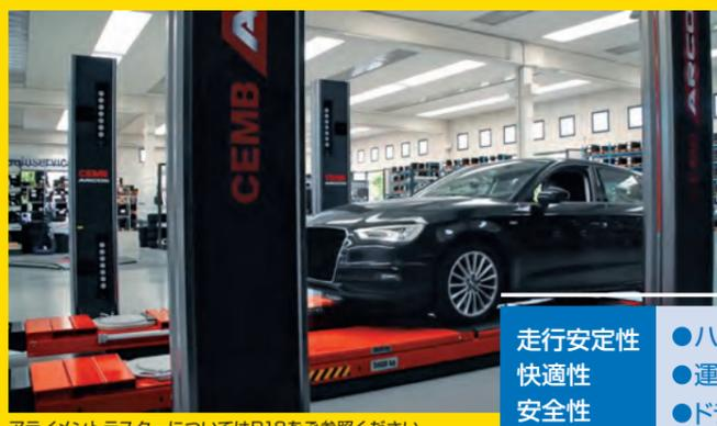
先進安全装置が正しく動作する上で、アライメントは非常に重要な要素です。アライメントが正確でない状態でエーミングを行うと、作業が正常に完了したとしても車両側の機能が正常に作動しない場合があります。そのためエーミング作業前には、ホイールアライメントの正しい測定が必要です
