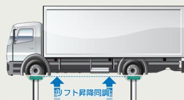
リフト昇降時の固定・移動リフトの同調機能で水平に昇降することが可能。安全性を確保します
