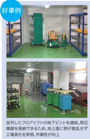
並列したフロアリフトの地下ピットを連結。周辺機器を格納できるため、地上面に物が散乱せず工場美化を実現、作業性が向上
