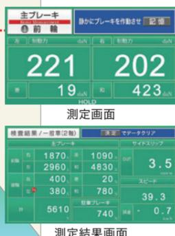
BSテスター/サイドスリップテスターにこれ1台でモニター接続可能。全ての測定が完了してから測定データ結果をまとめて表示。電波式リモコンのため大型車や左ハンドル車でも操作が容易
