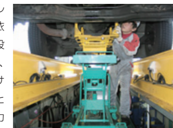
フロアリフト内部にミッションリフトを収納! 工場内がスッキリし作業もスムーズ!
