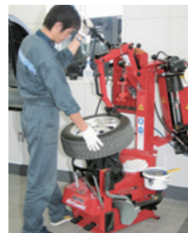
2種類のビードプレーカーでオールラウンドに対応するエアコンビ
