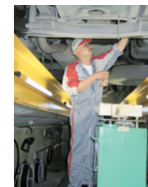
高さの調整ができ、メカニックのベスト ポジションで作業ができるフロアリフト
