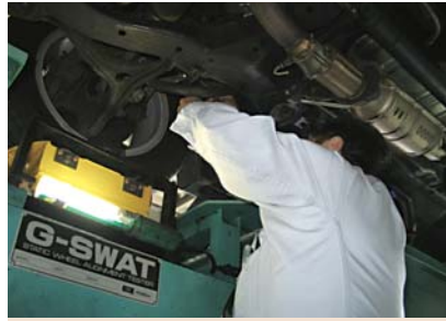
タイヤの性能を充分に発揮できるよう G-SWATで足回りのスレを補正
