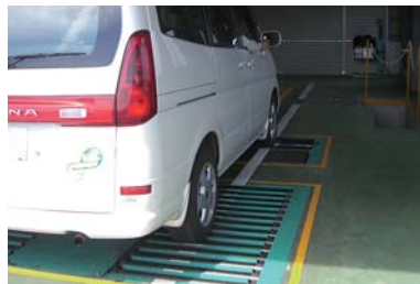
4WD車の入庫が多い雪国では 多軸フリーローラーが必要
