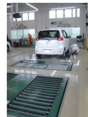
サービスエンジニア待望の“多軸フリーローラー”は作業を効率化!
