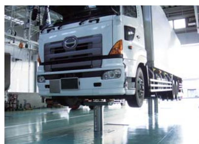
4柱式“ツインパワーリフト”は、車両に応じて様々な使い分けられる
