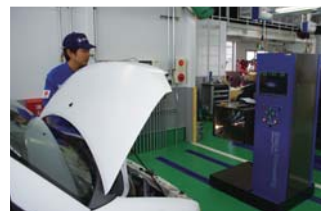
「全自動ヘッドライトテスター」は 作業の効率化を重視し導入
