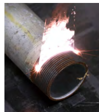
錆びたねじ山に レーザークリーナーを施工
