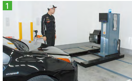
“全自動ヘッドライトテスター”は前後移動式を採用。1mの測定距離を自動検出
