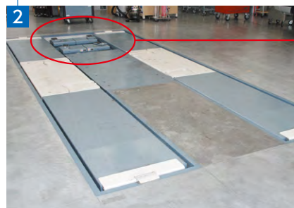
ドライブオンの“フォーマルリフト”は乗用車でも重量のある車両の整備に対応
