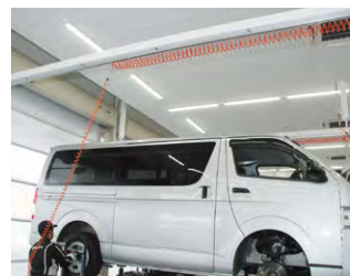
エアツールのコードは取り回しを考慮しレール移動式に。カールの大きさにもこだわった
