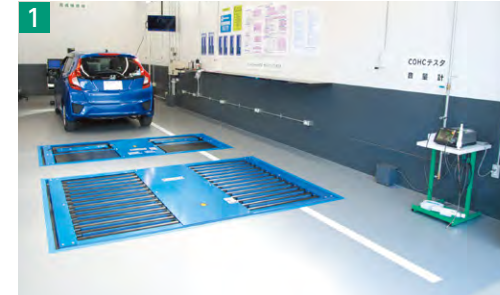
トータル車検ラインシステム“ラインマスター”を導入し、自動車検査登録情報協会「スマート継続OSSシステム」と新たに連携されたことで、従来よりもさらに使いやすく、作業時間も短縮
