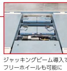
ドライブオンの“フォーマルリフト”は乗用車でも重量のある車両の整備に対応
