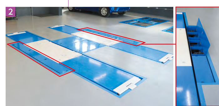
“マルチリフト”には収納ボックスを設置。様々なアタッチメントを収納可能で、作業の安全性向上と工場美観に寄与
