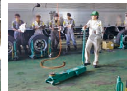
▲ガレージジャッキ フレームやアーム部に変形がないか、車輪の動作状況などを確認。走行性をチェック
