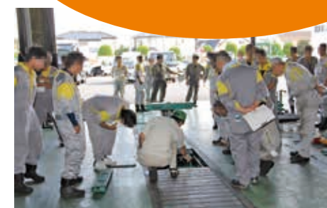
▲パンタ式リフト リンク部の軸やボルトに緩みがないか、リフト上昇時に降下止め装置の作動音がしているか
