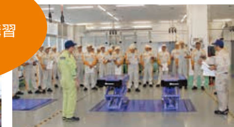
▲パンタ式リフト リンク部の軸やボルトに緩みがないか、リフト上昇時に降下止め装置の作動音がしているか
