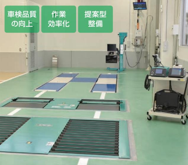
システムとの対話式入力でミスを軽減。液晶モニターを見ながら、リモコン操作で検査項目を選択・決定。検査員のストレスを軽減し、スムーズで効率的な検査をサポート
