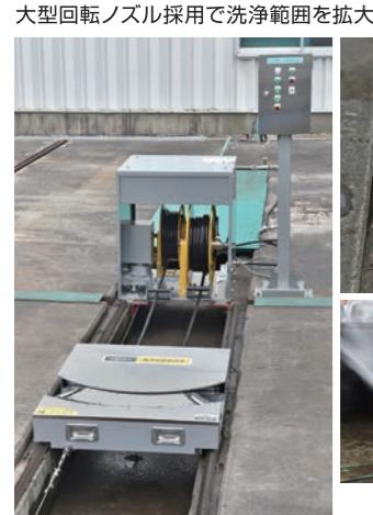
大型回転ノズル採用で洗浄範囲を拡大
