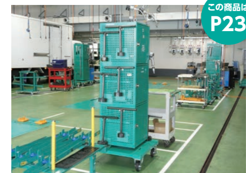
ハンドツール類は回転工具台車で整理整頓。 吊り下げツールボードが不要になり工場美化に貢献
