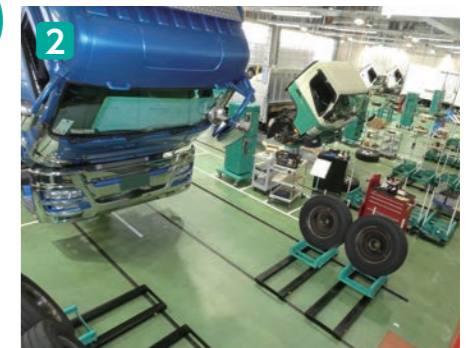
レール式ホイールドリーを備えた 大型ラインと中・小型ライン
