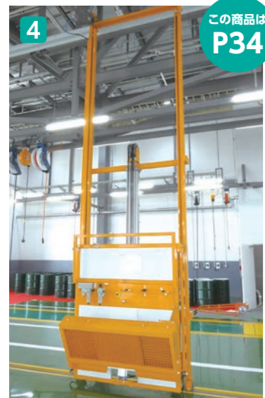
大型車の上部整備の際、安全性を高める ためにエア式アクセスリフトを採用
