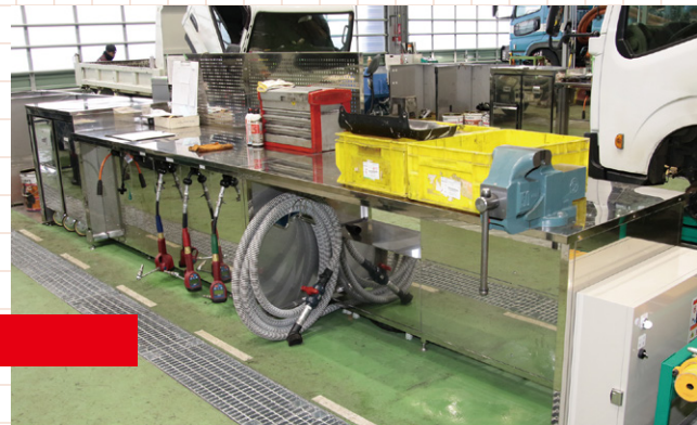
▲特注のステンレス作業台には各種リールやバキュームホースなどが格納されており、作業効率化に寄与
