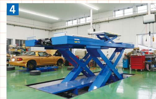
▲ビッグユースドライブオンリフト“BUD60UJ”を新設。クラス最高となる6トンの能力でレッカー車整備を内製化
