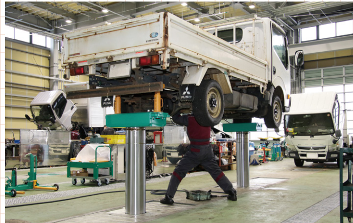
▲亜鉛メッキ仕様の“4柱式ツインパワーリフト”は、大型車はもちろん、小型トラックを2台同時に整備することが可能で作業効率向上
