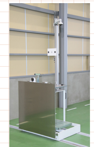
▲ヘッドライトテスターのレールを併用してエーミング用ターゲットを設置
