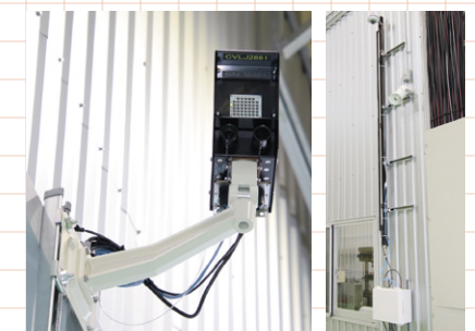
▲“3次元測定システム”と“車高測定装置”の導入で情報精度を高め、作業効率化も実現
