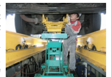
フロアリフト内部にミッションリフトを収納! 工場内がスッキリし作業もスムーズ!
