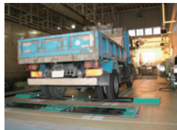
運転席に座ったままモニター画面で 測定結果が確認可能なラインマスター
