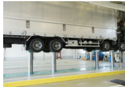
工場長絶賛の4柱リフトは用途に合わせて使い分けが可能
