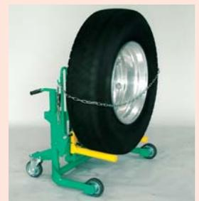
足回り整備の確実な作業をサポートするホイールドローリーのショートタイプが登場しました。フォーク部が320mmと短いので、ダブルタイヤ1本ずつの脱着作業がスピーディーで、ハブボルト・クリップボルトの点検作業に適しています。全長は645mm(当社比-275mm)のコンパクトサイズで、移動もラクラクです。
