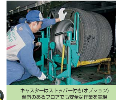
フォークが回転するので タイヤの位置合わせがラクラク!
