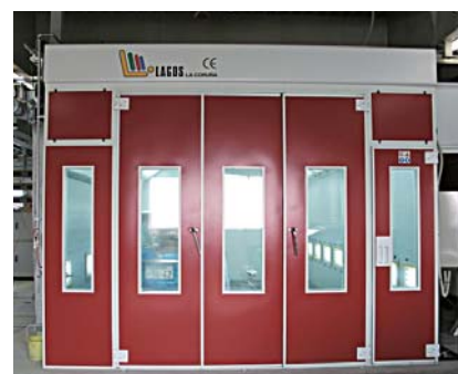
将来性を考え、水性塗料にも対応できる 塗装ブース
