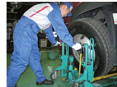
フォークが回転するので タイヤの位置合わせがラク!
