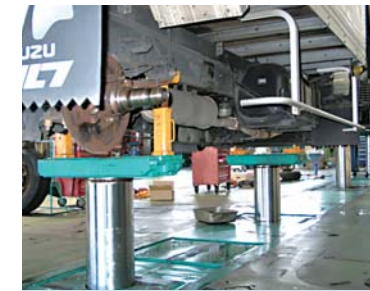
上昇時もフラットな床面 安全面に配慮した作業が可能
