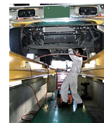
多目的に使える2分割“フロアリフト” 自由な高さ設定でメカニックの負担を軽減
