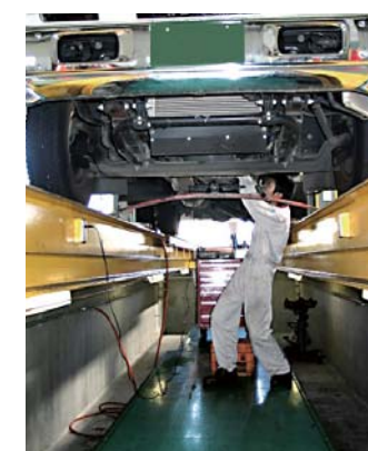
多目的に使える2分割“フロアリフト” 自由な高さ設定でメカニックの負担を軽減
