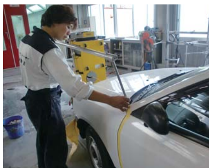
3次元計測器“タッチ”で損傷箇所を正確にチェック
