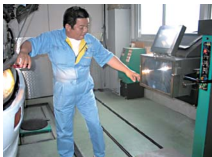
“画像処理方式手動ヘッドライトテスター”は、抜群の精度で瞬時に測定を完了!
