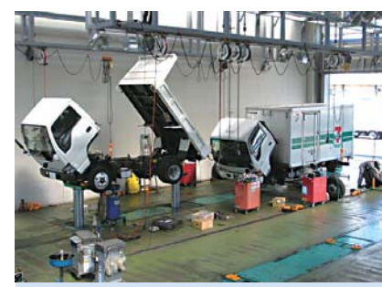
2台を1ストールで整備できる4柱式“ツインパワー”
