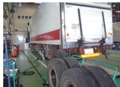
「レール式ホイールドロー」を組み合わせると足回り整備を強化
