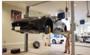
車幅や天井高さに合わせリフトは特注仕様
