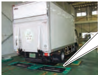
飛散したグリスの清掃も、ステンレス 鋼板を敷くことでラクに行えます!
