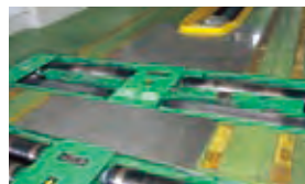
飛散したグリスの清掃も、ステンレス 鋼板を敷くことでラクに行えます!
