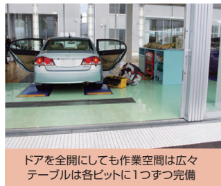
万が一の感電を防ぐ絶縁マット 水を使わないようフローリングにしたのも、HV整備への配慮
