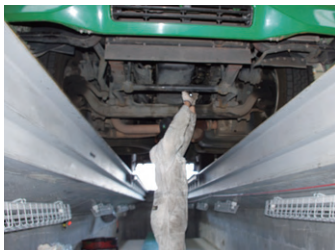
車両の下回り整備や点検が 安全・かつ効率的にできる“2分割フロアリフト”
