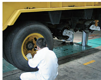
“ツインパワーリフト”を導入したことで 足回り整備も効率化
