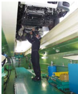
オイル交換や下回りのクイック整備に最適なフロアリフトは2分割タイプを導入
