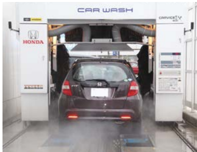
「カービスEX eco」と組み合わせた「下部洗浄システム」で車両下回りまでしっかり洗浄
