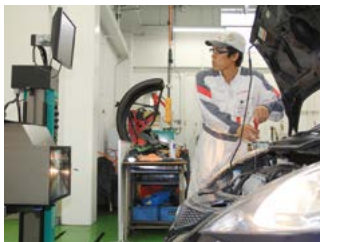
エルボー一点の表示が速く扱いやすい「画像処理方式ヘッドライトテスター」
