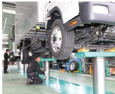
中・小型トラックの2台同時整備が可能な4柱式ツインパワーリフト
