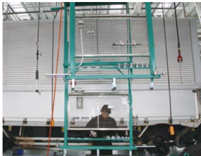
オリジナルの吊り下げ式工具ボード。工具や部品の床置きをなくすだけでなく、使いやすさも格段に向上
