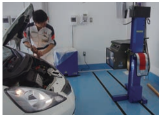
正確な光度を捉える「画像処理方式ヘッドライトテスター」は整備の効率化に貢献
