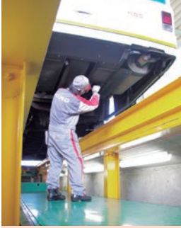
県内初設置となる「2分割フロアリフト」。車両を乗入れるだけで即整備が可能で、特にバスの整備に重宝している
