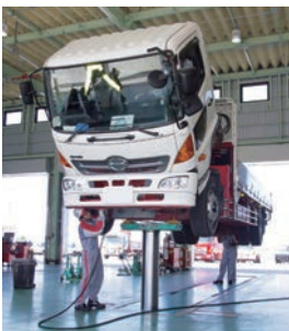
「ツインパワーリフト」は、車両乗り入れからリフトアップまで、スピーディーなセッティングを実現
