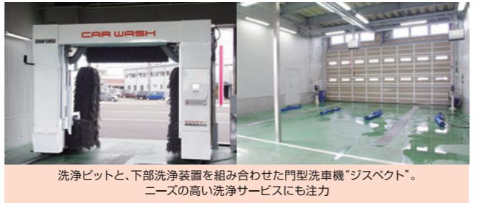
洗浄ピットと、下部洗浄装置を組み合わせた門型洗車機“ジスペクト”。
