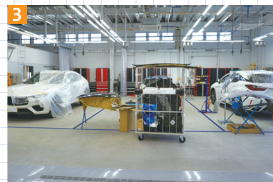
▲钣金ストール。左はアルミ専用ストール。アルミパネルの修理を積極的に実施
