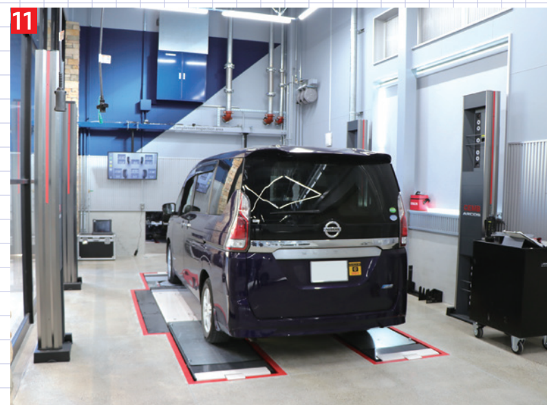
▲タッチレスホイールアライメントテスター“ARGOS(アルゴス)”を用いて入庫車の全数診断を実施。4本の支柱に搭載されたカメラにより、高精度な測定を実現
