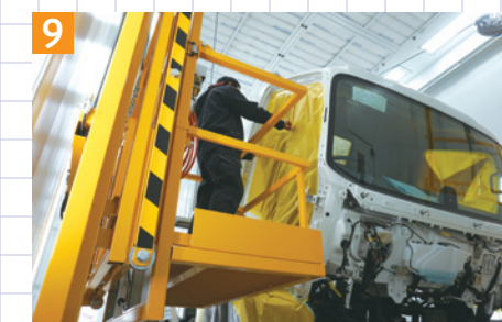
▲“エア式アクセスリフト”を用いて大型車上部の塗装などを安全かつ効率良く作業
