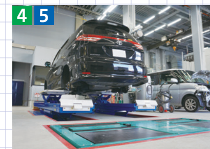
▲検査ラインはサイドスリップ、ブレーキ、スピードの複合試験機、“ハイブリッドテスター”とドライブオンリフトの“マルチリフト”
