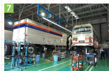
▲増加している車検整備には作業効率化を図るツインパワーリフトでカバー
