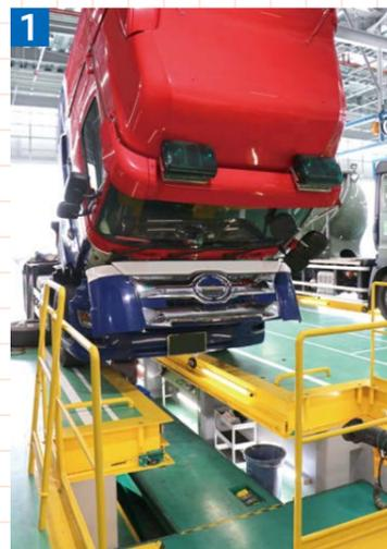
▲点検入庫が増加する中、フロアリフトの導入により、メカニックの負担軽減と作業効率化を実現
