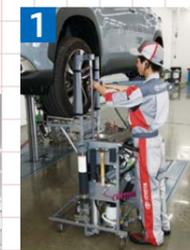
▲完成検査ライン横は車検ストール。アルネオリフトに内蔵のエア接続口を設け、システム台車に対応しつつ、ホース接触による車体損傷リスクを低減
