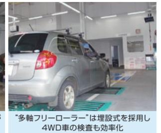
“多軸フリーローラー”は埋設式を採用し4WD車の検査も効率化
