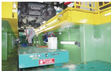
“3分割フロアリフト”の内部は広々。作業に応じて高さ調整ができ、クイック整備に最適
