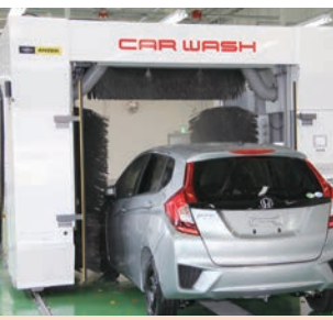
室内設置のため、最短レール長7.8mの門型洗車機 “ジスペクト”を採用。作業者への騒音も考え、 静音型ドライブシステム“クリスタルイン”も導入
