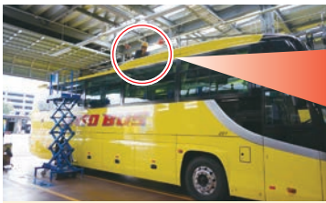
車両上部にあるエアコンの整備は年1回車検と同様に実施。 高所作業のため、安全対策にも注力
