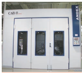
塗装ブース“CAB-11”。中古車の再販をする ために下取りした車両の塗装など塗装関連の 作業は全てここで対応
