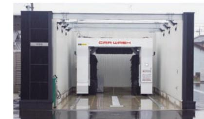
門型洗車機“ジズペクト”は3面に防音壁を採用することで騒音対策を強化
