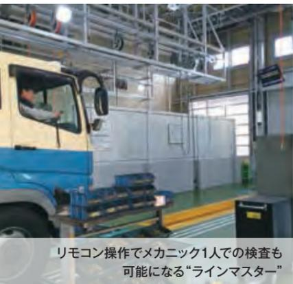
リモコン操作でメカニック1人での検査も
