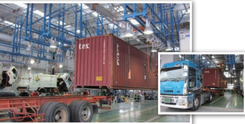
▲コンテナを積載したまま整備スツールに入庫しコンテナ用クレーンで脱着後、整備および検査が可能となりました
