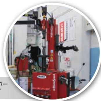
イヤチェンジャー「モモスピード」を導入。「スバル車は低扁平で大口径タイヤが多いので、安全性が高くメカニックに負荷が掛かりにくいレバースは重宝しています。今後もタイヤ専門店にも負けないスピードで対応していきたいですね（杉澤サービス課長）。
