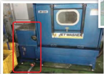
▲ 部品洗浄機は、検討を重ね洗剤タンクの高さをアップした特別仕様。泡の流出を防ぎ、床汚れを防止
