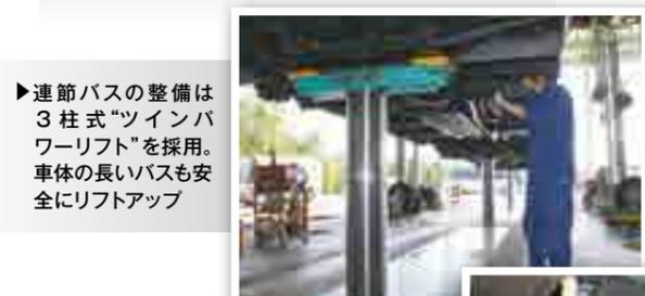
▶連節バスの整備は3柱式「ツインパワーリフト」を採用。車体の長いバスも安全にリフトアップ
