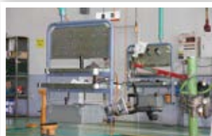
▲車検整備用の各ストールに設置された工具ボード。回転式のため、隣接するストール間での併用が可能
