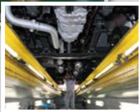
◀キャスター式に比べ位置決めがしやすく、効率化に貢献する“レール式ホイールドローリー”
