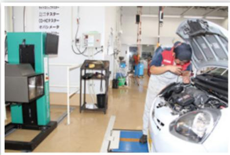
▲全自動の「カラー画像処理方式ヘッドライトテスター」の採用で測定精度が向上
