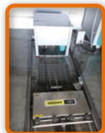
▶洗車ストールは建屋内にワックス仕様の「ジスベクト」を設置。下部洗浄装置と連動させることで車両下部の塩害をしっかりと対策
