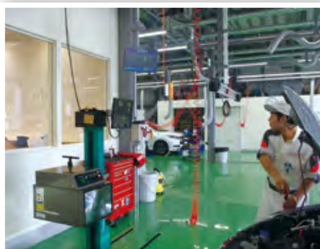
▲LEDにも対応する「画像処理方式ヘッドライトテスター」は正確性と操作性に優れ、作業効率が向上
