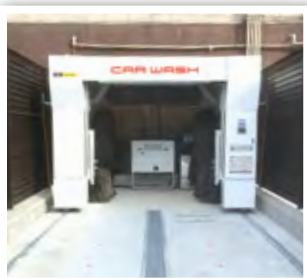
◀門型洗車機「ジスペクト」は、ボディに優しいマシエルブラシを採用。手洗いよりソフトな洗い心地で仕上がりも良好。節水効果も高く、使用する水量が以前の半分に
