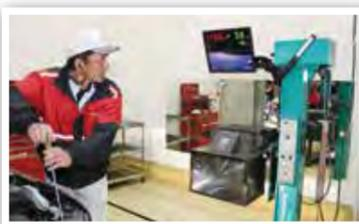
▲光の色味を判別できる「カラー画像処理方式ヘッドライトテスター」。検査ライン前面には横3m、縦1mの大きな姿見を設置し、検査業務を効率化
