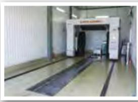
◀洗車ストールにはスイッチ1つで下回り洗浄まで可能な「下部洗浄装置」連動の門型洗車機を導入し、洗車作業を効率化
