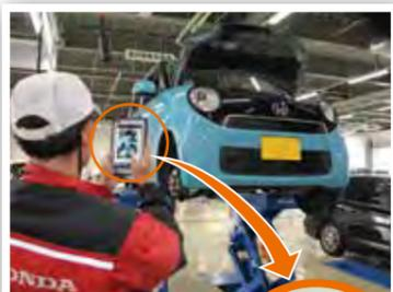
▲専用タブレットで車検証のQRコードを読み取り入庫車両を撮影することで、画像と車両データを自動で紐付けする「タブレット版車両画像取得装置」。登録データはサービス事務所に設置したパソコンで参照・印刷ができる
