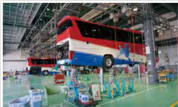
▲「2柱式ツインパワーリフト」は整備ストールに大型車用12基中・小型車用6基を導入。増加する小型トラックへの対応力を高めたレイアウト
