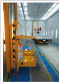
▲塗装ブース内にはレールに沿って360度広範囲に移動できる「エア式ゴンドラリフト」を導入し、高所作業の安全性・作業性を向上
