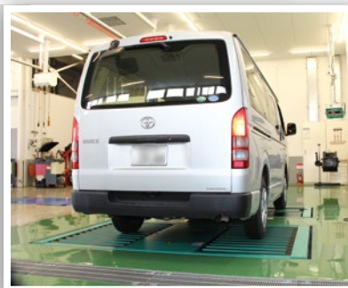
▶ハイブリッドデスターと組み合わせて設置された多軸式フリーローラーで4WD車に対応可能
