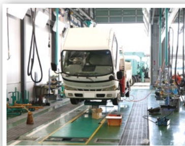
▲「4柱式ツインパワーリフト」は小型トラック等の縦列整備にも対応。通り抜けを可能としたスルーレーンの活用によって作業効率が向上
