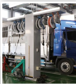
▲「4柱式ツインパワーリフト」は小型トラック等の縦列整備にも対応。通り抜けを可能としたスルーレーンの活用によって作業効率が向上
