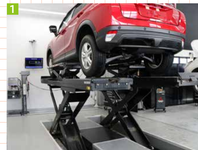
▲車検ラインにはトータル車検ラインシステム“ラインマスター”や“マルチリフト”を導入し、作業効率化に寄与
