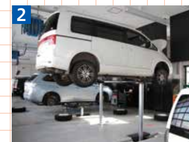
◀重整備からクイック整備まで幅広く対応できるアームタイプの“アルネオリフト”を導入
