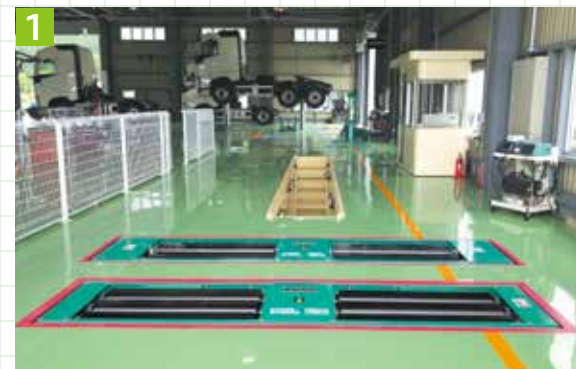
▲車検ラインシステム“ラインマスター”を導入。検査業務をシステムでトータルコントロールすることにより車検品質を向上し、検査業務の効率化も実現。また“カラー画像処理方式手動ヘッドライトテスター”を導入
