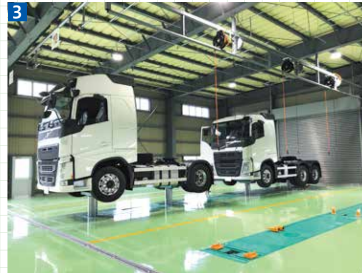
▲“4 柱式ツインパワーリフト”。大型トラックはもちろん、トラクターヘッドや小型トラックの縦列整備も可能で作業効率向上
