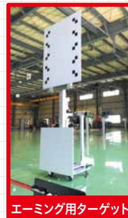
▲アライメントテスター“トラックカム(ボルボ仕様)”はアニメーションに従うだけの簡単操作で、アライメント計測が可能。エーミング用ターゲットも導入し、サービス性向上
