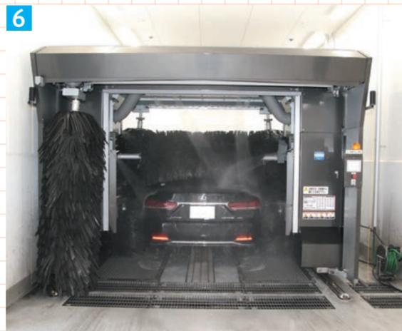
▲静音システムを搭載した省スペース型門型洗車機“ゼクス”は全長5mの車両が洗浄可能。下部洗浄装置で下回りもすっきり洗浄
