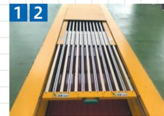
▲開口部には“シャッター式フロアリフト落下防止装置”を設置
