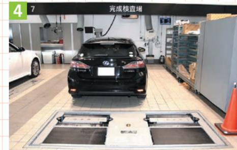
▲完成検査場はトータル車検システム“ラインマスター”で管理し、検査業務を効率化
