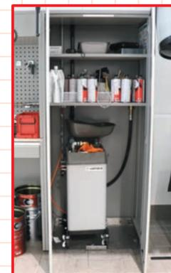
▲キャビネット内には、集中廃油システムの端末が設置されており、廃油カートをキャビネット内に収納すると自動で廃油を回収
