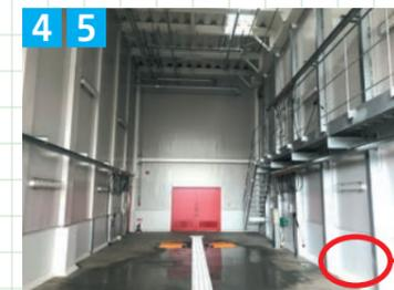
▲管を埋設し騒音を低減、雪落としに便利なキャットウォークも設けた洗車ストール
