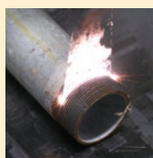
錆びたねじ山にレーザークリーナーを施工
