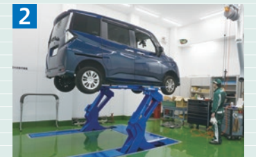
▲リフトは昇降時に音と回転灯による注意喚起を行う安全設計
