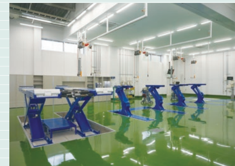
▲マルチリフト(左)とアヴェンタスリフト(中央・右)検査ラインを含めて全6ストールを配備
