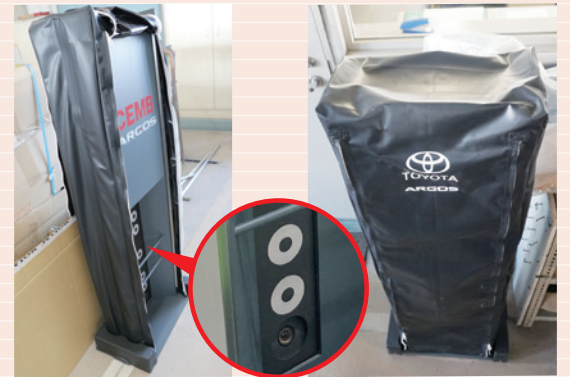
▲コラムに取り付けられたカメラが車両のホイールの角度を検出し、トーとキャンバーを自動測定
