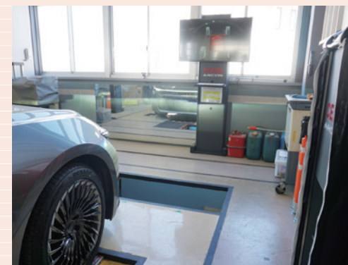
▲車両停止後、5秒〜10秒でトーとキャンバーの測定を完了
