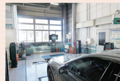
▲アライメントストールへの入庫。車両を検知し自動で測定を開始
