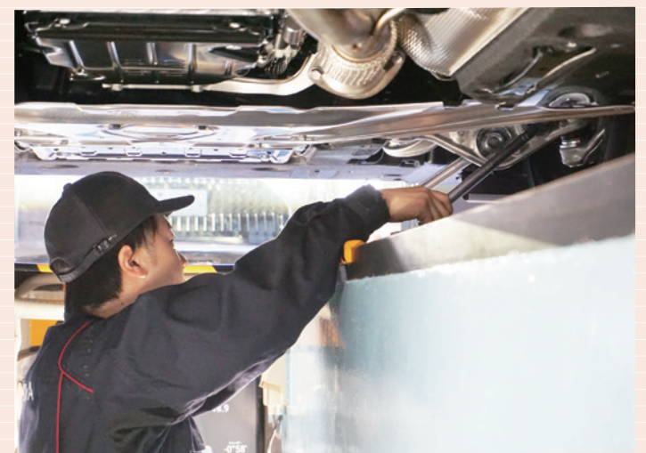
▲ピットでアライメント調整を実施。LEDの作業灯は角度を工夫し、視認性・快適性を向上
