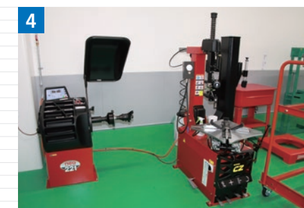
▲ホイールバルンサー“neo221”は作業時の事故を防ぐため、オプションの“ホイールカバー”を採用
