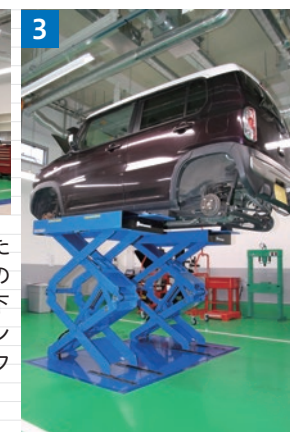
▲クイック整備に適したドライブオンタイプの“マルチリフト”(左)と下回り点検が容易なパンタ式“ステイタスリフト”(右)を各2基導入
