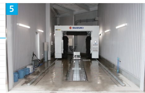
▲省スペース型の門型洗車機“ジズベクトⅢ”には騒音に配慮した静音仕様のオプションを搭載
