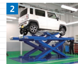
▲クイック整備に適したドライブオンタイプの“マルチリフト”(左)と下回り点検が容易なパンタ式“ステイタスリフト”(右)を各2基導入
