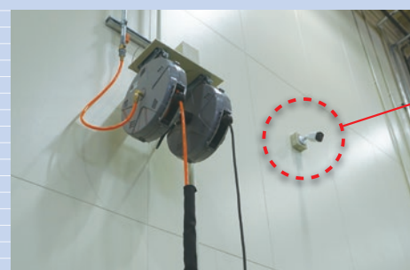
▲スTool毎にカメラを設備。整備のプロセスをエビデンスとして記録
