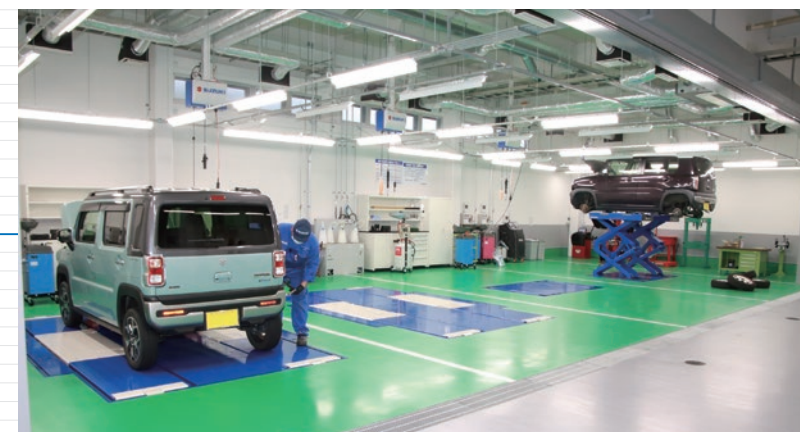
▲4基のリフトは安全性を重視していずれもフルフラットタイプを選択
