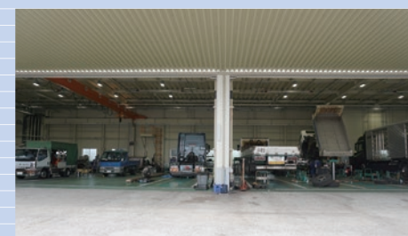
▲全10スToolの新工場。1スToolの幅を5,500mmとし、ゆとりをもたせることで、雨の日も軒下で作業可能
