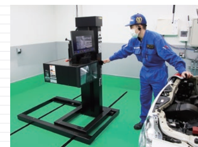
▲“手動式前後移動ヘッドライトテスター”の採用でセッティングの時間短縮に貢献
