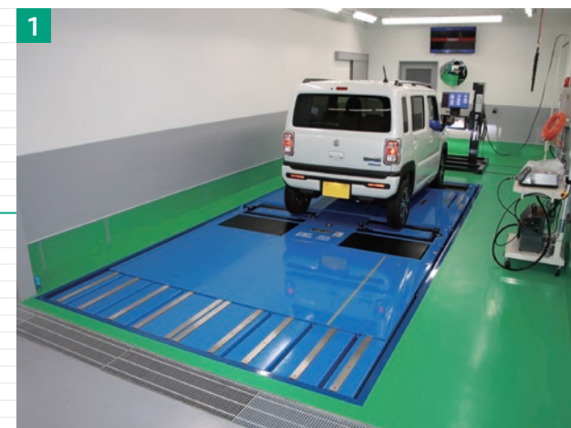
▲“4WD対応ABSテスター”を導入した完成検査ライン。前輪のセット完了後、後輪の位置に合わせてテスターが移動
