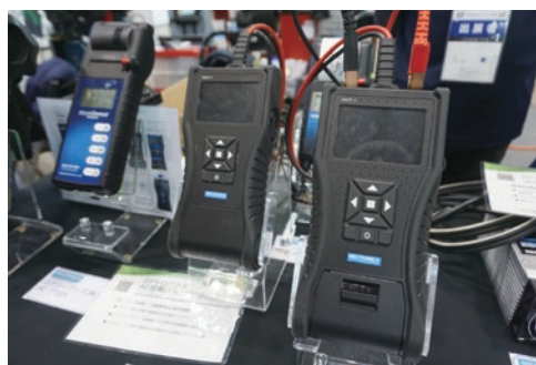
プリンター付きタイプ(右)と プリンターなしタイプ(左)を設定。 診断結果のメール送信が可能
