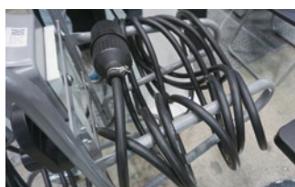
ケーブルが ねじれないよう、 8の字による ケーブル収納
