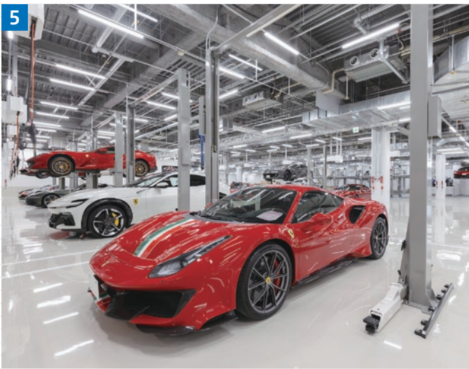
▲2列に整然と配置された10基の特注の幅広仕様の“門型リフト”。アンダーカバーが車体下面全体に装着された車両でも安全にリフトアップでき、かつドアの開閉時も気にすることなく作業に集中。先端が薄い3段式アームを採用
