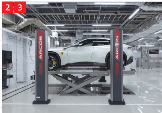
◀▲“ARGOS”は納車スペースから見える場所に配置され、お客様からの信頼獲得にも寄与。“マルチアライメントリフト”は電動車対応を見据え能力を3.5tにアップ
