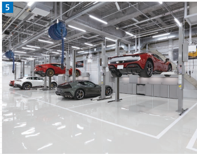
▲2列に整然と配置された10基の特注の幅広仕様の“門型リフト”。アンダーカバーが車体下面全体に装着された車両でも安全にリフトアップでき、かつドアの開閉時も気にすることなく作業に集中。先端が薄い3段式アームを採用
