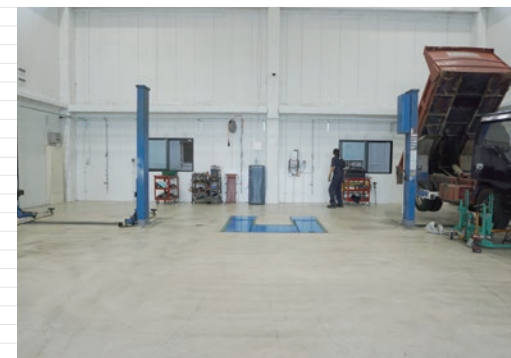
▲小型トラックの整備用として“トータスリフト”(中央)を新たに納入。リフト手前でも特殊車両の整備ができる広さ
