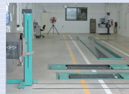
▲検査ライン前のヘッドライトテスターは検査ラインへの入庫が難しい大型建設機械用。そのためライン手前は広大なスペースを確保
