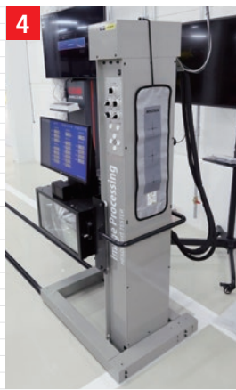
◀光軸調整等のためカラー画像処理方式の手動ヘッドライトテスター“HLI-223”を導入
