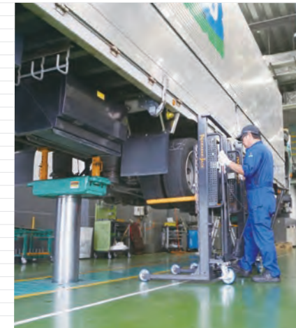
▲メカニックが負担の少ない立ち姿勢のまま作業できる仕組みは、入庫数の多い現場での作業効率に不可欠
