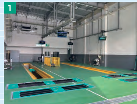
▲拡大する車検需要に応える2ラインの検査場。右の検査ラインはエーミング作業場も兼務
