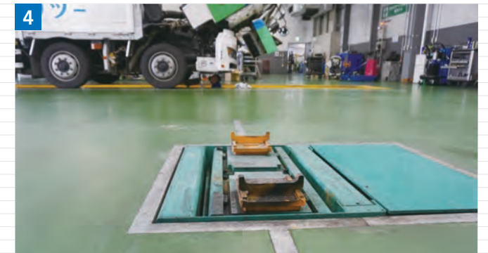
▲クイック整備用に“テストリフト”を1基納入。フローティング式スライドアームで幅広い車種に対応
