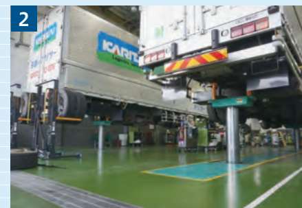
▲“ツインパワーリフト”(2柱式30t)は6ストールに納入。電動スライドアーム仕様を採用、さらにメカニックの作業負担を軽減
