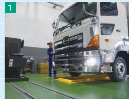
▲LED化が進む大型車のヘッドライトに対応するため“カラー画像処理方式全自動ヘッドライトテスター”(HLI-2023)を導入
