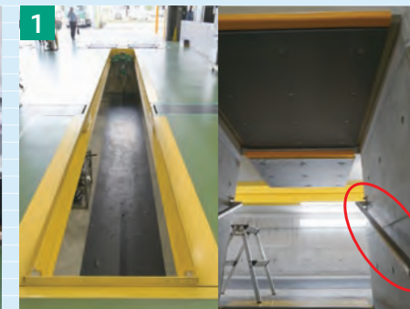
▲メカニックの安全確保を最優先に、点検ピット内は手すりや頭上にはクッションを設置
