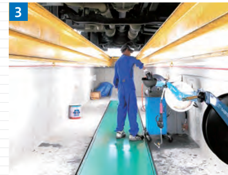
▲小型の整備と併用できる“フロアリフト”は2分割式を導入
