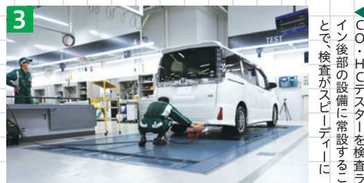
3 鏡ではなくモニターを使って車両を検査ラインに合わせることで可能。車両の灯火類の検査も楽に行える
