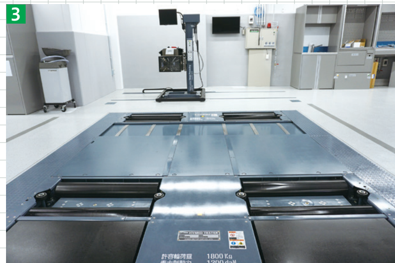
▲ラインマスターをはじめ、4WD対応のBSデスター、ヘッドライトデスターを導入した完成検査ライン
