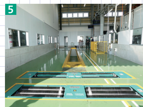
前後で4m、3mを同時に作業する機会が多く、2分割フロアリフトはフル回転で活躍
