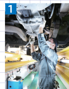
前後で4m、3mを同時に作業する機会が多く、2分割フロアリフトはフル回転で活躍
