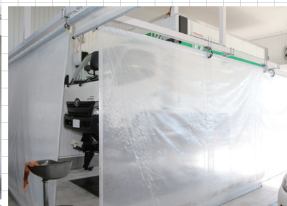
▲ドライブオンタイプの“フォーマルリフト”。アンダーコート塗布時の飛散防止で自動式の間仕切りロールカーテンを天井に設置
