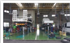
▲2基の“フロアリフト”の地下ピットを連結させて、分解作業場として使用。オイル交換やミッション分解作業もピット内で完結
