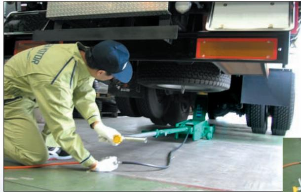
600mmの延長ハンドルを取り付けることによりハンドルを倒した際、受皿からハンドル握りまでの長さが3255mmとなり、従来のジャッキより車両の奥まで挿入が可能になります。
